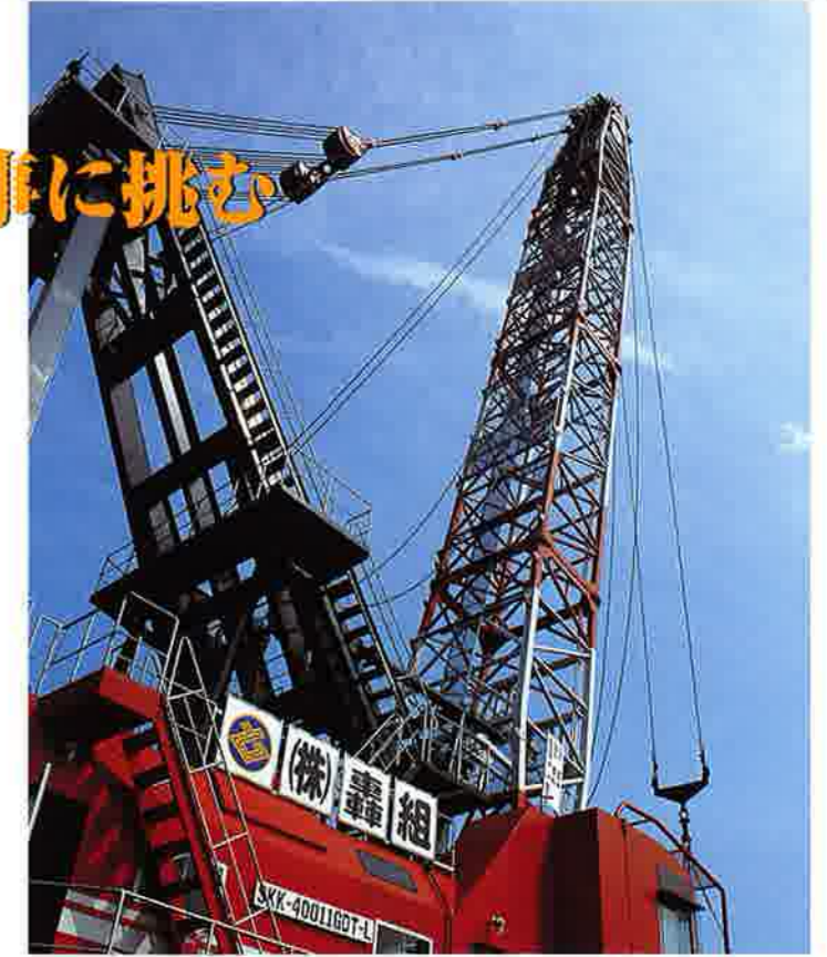
主巻フック自重 11to 第一補巻フック自重 1.5to 第二補巻フック自重 0.2to
